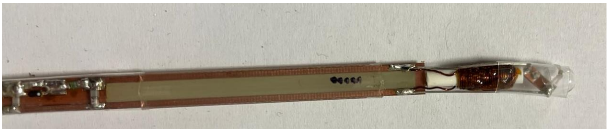
Circuit TDO cu cristal SCO integrabil în criostatul MPMS3 cu He lichid.
