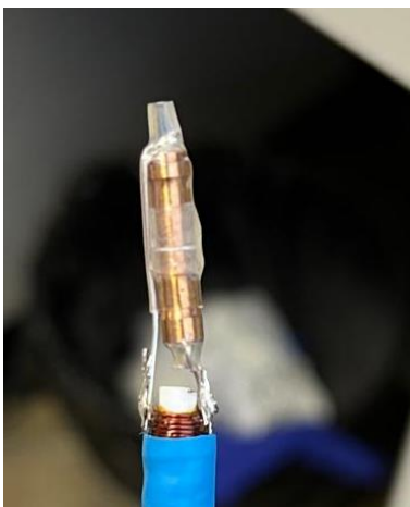
Pudra SCO între doi electrozi de Cu, utilizat ca element activ în circuitul TDO
