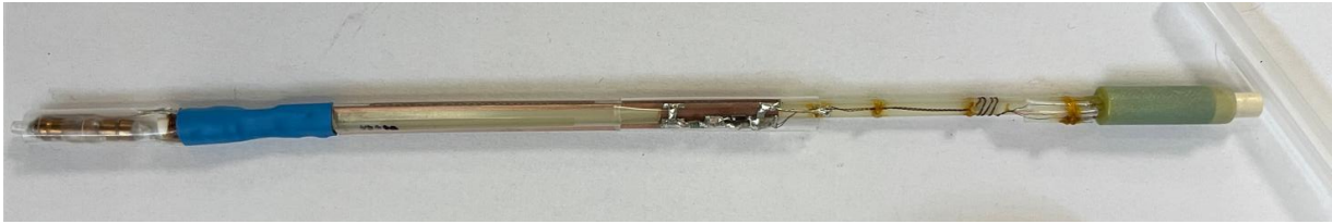
Circuit TDO cu pudra uscata nanoparticule SCO integrabil in criostatul MPMS3 cu He lichid.
